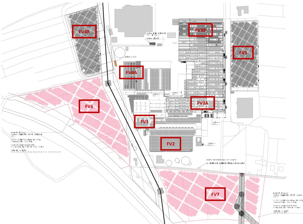
**Figura 6: Planimetria dello stabilimento con indicata la posizione delle sezioni dell'impianto fotovoltaico.**
