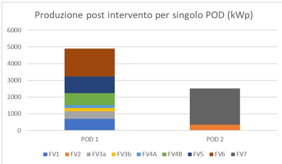
Figura 8: Produzione annuale per singolo POD (kWp), condizione post installazione FV6 ed FV7.
