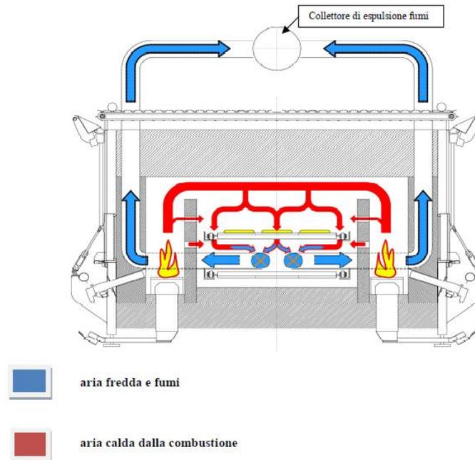
Figura 13: Schema di funzionamento del forno di cottura pizze
