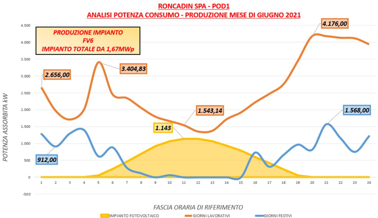
Figura 9: Curve di prelievo e produzione POD1 – giugno 2021.
